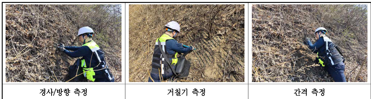
【사진 1.3.3】 1구간 불연속면 측정 현황
